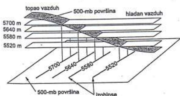
Slika 5.5: Šematski prikaz 500-mb površine i njene projekcije na horizontalnu ravan
