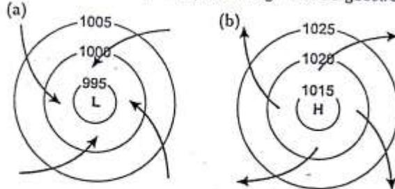
Slika 5.20: Strujanje vazduha pri liti u ciklonu (a) i antiklonu (b).
