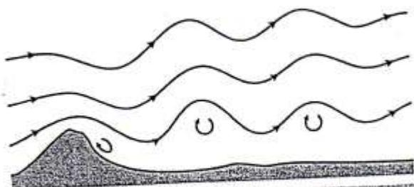
Slika 5.23: Modifikacija horizontalnog strujanja vazduha pri nailasku na orografsku prepreku.
