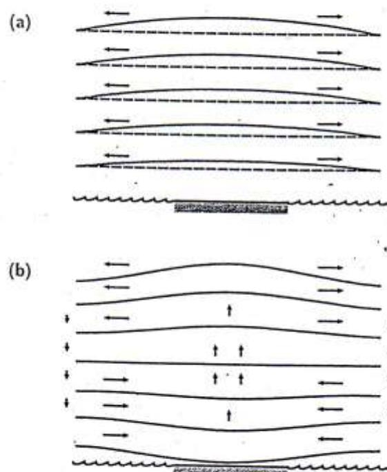
Slika 5.12 Strujanje vazduha iznad nejednako zagrejane podloge
