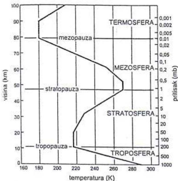
Slika 1.2. Vertikalni profil temperature u "standardnoj" atmosferi
