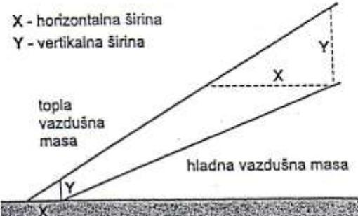
Slika 6.1: Vertikalni presek vazdušnog fronta
