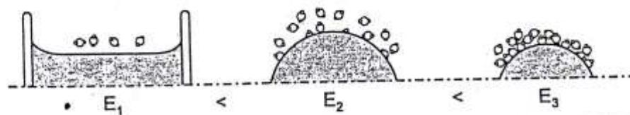
Slika 4.5: Maksimalni napon vodene pare u zavisnosti od zakrivenosti vodene površine.
