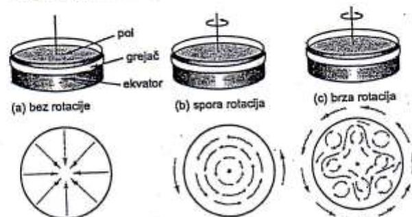
Slika 5.25. Laboratorijski model opšte cirkulacije atmosfere
